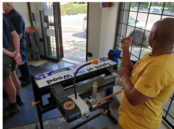
Staander en draaibank vir gebruik met 'n rolstoel/ Stand and lathe for use with a wheelchair.
